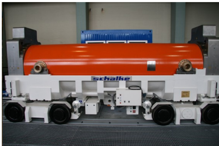
Abb. 5.6 Plateauwagen mit Transferbehälter
