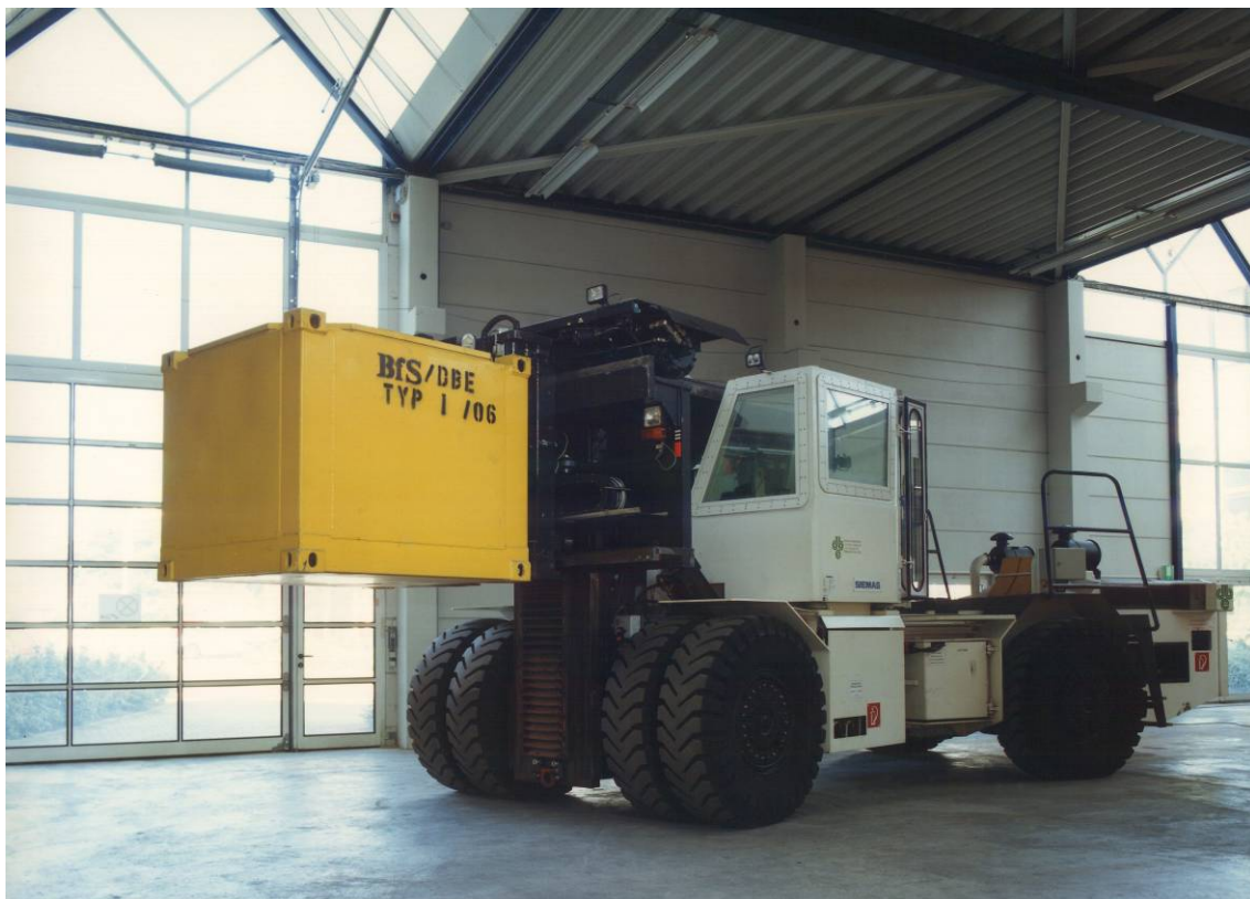
Abb. 5.15 Stapelfahrzeug für Abfallgebinde mit Abfällen mit vernachlässigbarer Wärmeentwicklung
