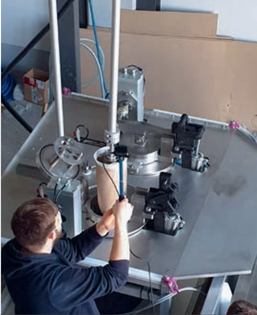
Videoaufnahme des fernhantierten Austauschs der Beutelfilter im Rahmen einer Onlineschulung noch während der Corona-Einschränkungen.
