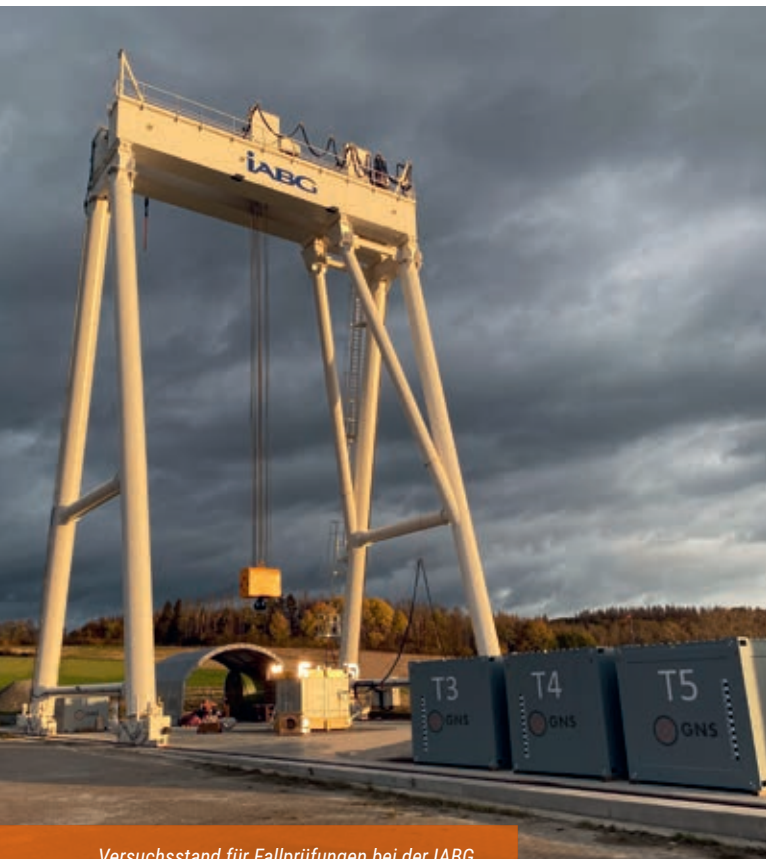
Versuchsstand für Fallprüfungen bei der IABG.
