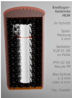
Endlager-Gebinde im Schnitt.jpeg 480K
