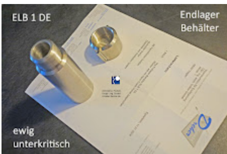
Es ist ein kleiner Behälter - klein weil gar keine kritische Masse hineinpassen darf .jpg 112K
