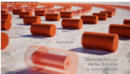
Gebinde-Prinzip Harter Behälter in weicher Hülle.jpeg 358K
