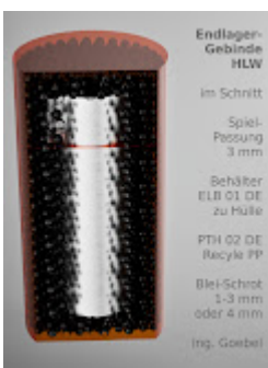
Endlager-Gebinde im Schnitt.jpeg 480K
