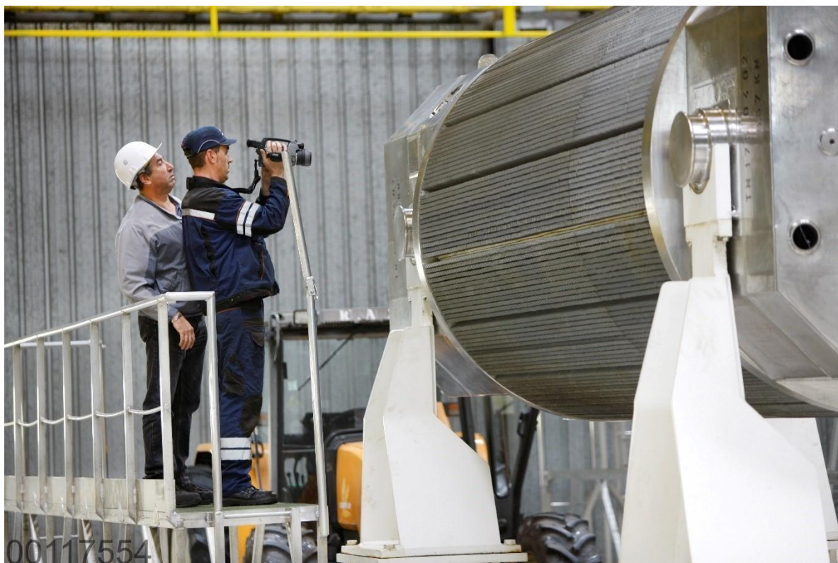
Figure Annexe 1-8 Exemple illustratif d'opérations de contrôle d'un emballage de transport menées sur une installation nucléaire
